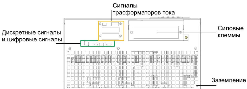
Рисунок 3-3 Расположение клемм силовых и контрольных цепей
