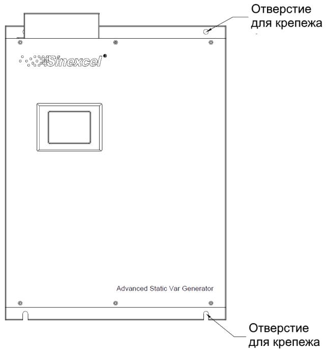
Рисунок 3-2 Крепления модуля для настенного монтажа
